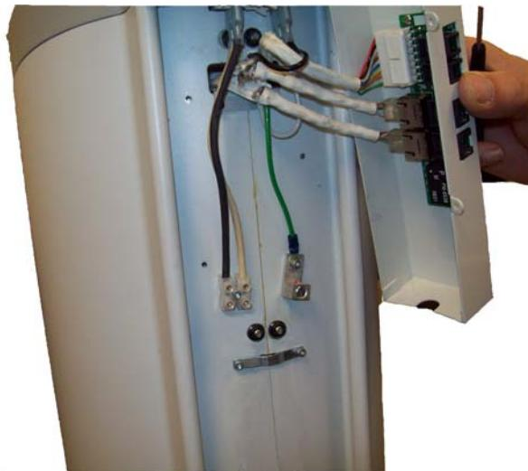
3. Odšroubujte šroub z odlehčení tahu, aby byl k vodičům přístup. Uložte jej na bezpečné místo pro pozdější montáž.
